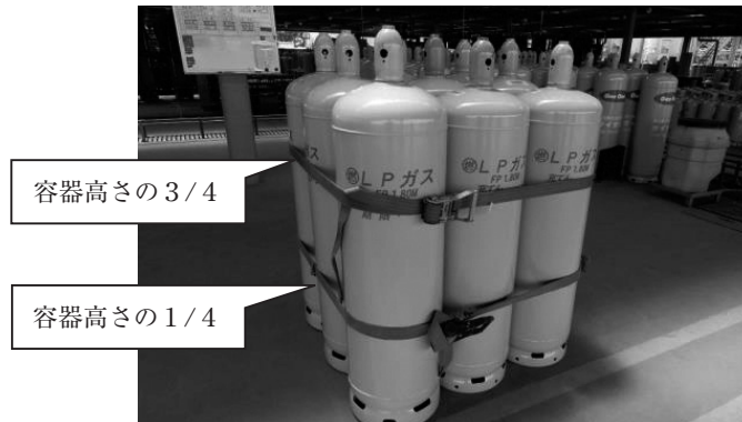
ラッシングベルトによる固定（例）
